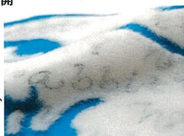
「フロッキー」とは、ナイロンやレーヨンの短纖維を高圧の静電気の力で素材に植え込む技法のことです、電車やバスのシートなどに使用されています。当社は、独自の技術を研究し、他には真似のできない「毛足の長い極細加工」「透かし加工」「緻密なグラデーション」など、ふんわり柔らかな毛質を生み出し、斬新で優れたデザイン性をプラスしたブランド「Be-anxious」を展開します。あらゆる素材へのフロッキー加工に挑戦しながらブランド拡大を図ります。
