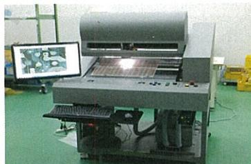
スマートフォンの高機能化をはじめプリント基板の小型化ニーズが高まる中、プリント基板製造工程における搬送装置の製造で培った独自技術や新開発の画像処理技術等を駆使した、より高精細・高倍率に対応できる新たな確認機を開発します。オペレーターの操作性も優れたこの新製品で新規顧客の開拓を進めます。
